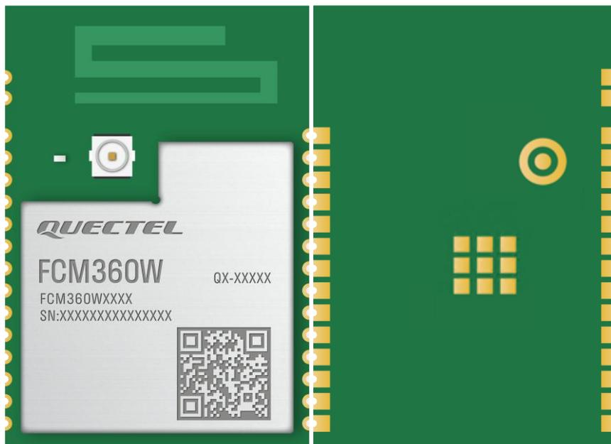
图 35: 俯视图和底视图 (射频同轴连接器)
