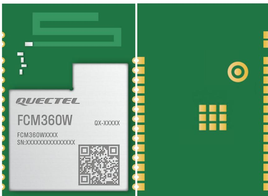
图 34: 俯视图和底视图 (PCB 天线)
