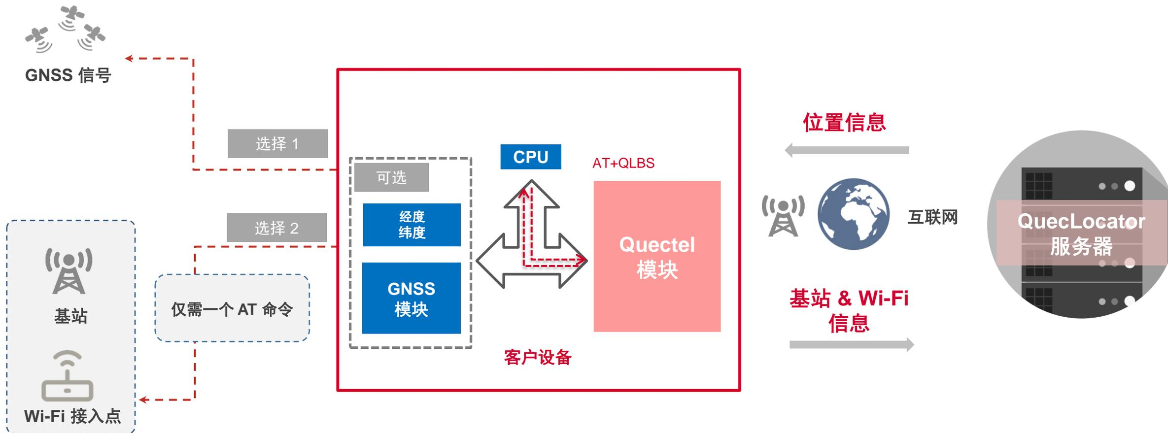
无需额外 GNSS 模块即可使用 QuecLocator<sup>®</sup>
