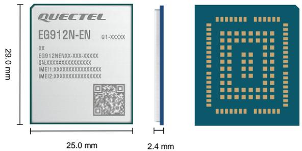
EG912N-EN 是移远通信最新推出的 LTE450 Cat 1 无线通信模块，支持450 MHz，支持最大下行速率 10 Mbps 和最大上行速率5 Mbps，具有超高的性价比。同时，在封装上兼容移远通信 GSM/ GPRS M35 模块、LTE Cat M1/ Cat NB2/ EGPRS BG95 系列模块、LTE Cat M1/ Cat NB1/ EGPRS BG96 模块、LTE Cat 1 EG91 系列模块和 LTE Cat 4 EG95 系列模块，实现不同网络间的无缝切换。
