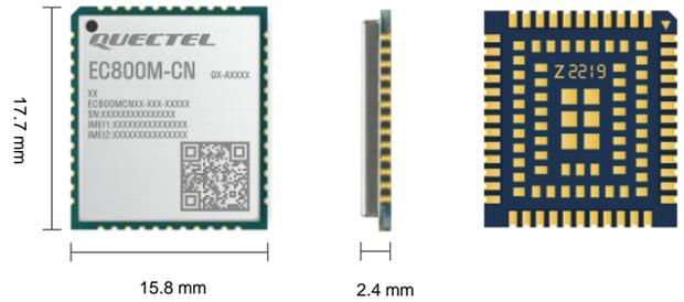
EC800M-CN 是移远通信专为 M2M 和 IoT 领域而设计的超小尺寸 LTE Cat 1 无线通信模块，支持最大下行速率 10 Mbps 和最大上行速率 5 Mbps，超小尺寸，超高性价比。同时，EC800M-CN 在封装上兼容 LTE Standard EC800E-CN、EC800G-CN、EC800N-CN、EC800K-CN 和 EG800K 系列模块。
