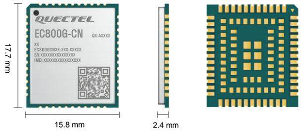
EC800G-CN 是移远通信最新推出的 LTE Cat 1 bis 无线通信模块，支持最大下行速率 10 Mbps 和最大上行速率 5 Mbps，具有超高性价比；同时在封装上兼容移远通信多网络制式 LTE Standard EC800E-CN、EC800N-CN、EC800M-CN 模块，以满足不同行业产品应用需求。
