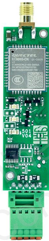
图 1：华系列 DTU 实拍图
